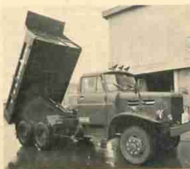
●巡回工事用に入った、全輪駆動の六トンダンプトラック。冬は除雪もできるスノウブラウ付。活動範囲が広くなって、機動力倍加。
