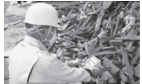
▲放射線測定装置で実際に測定
