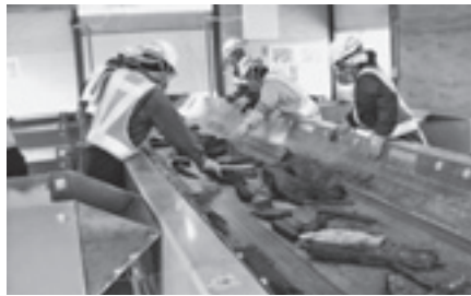
▲手作業で不燃物を取り除く様子
