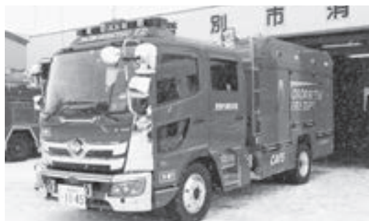
▲圧縮空気泡消火システムを搭載した新たな水槽付消防ポンプ自動車
